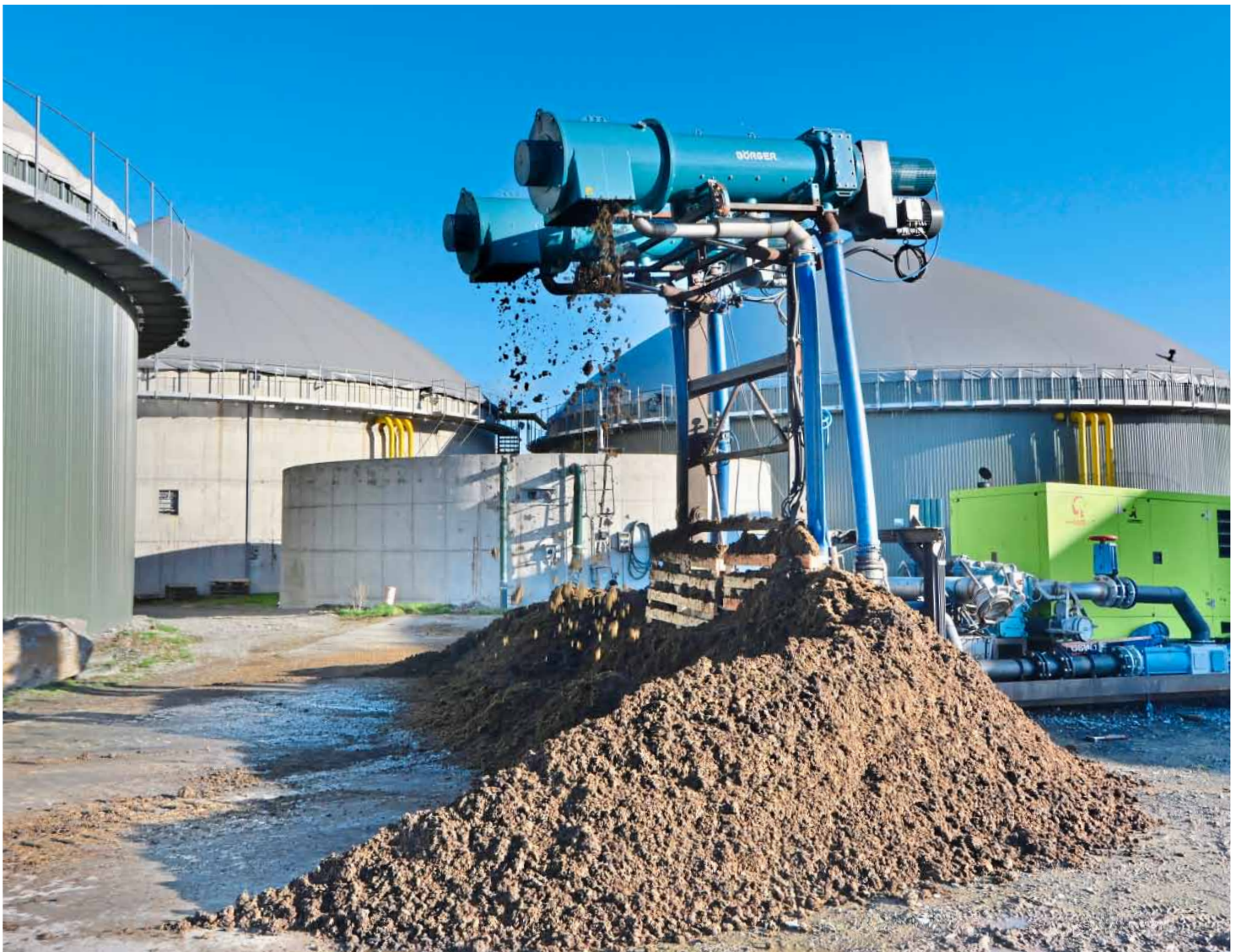
Die Gülleaufbereitung nimmt zu. Neben stationären Anlagen lohnen sich mobile Pressschnecken sowie Zentrifugen und Dekantertechniken.
