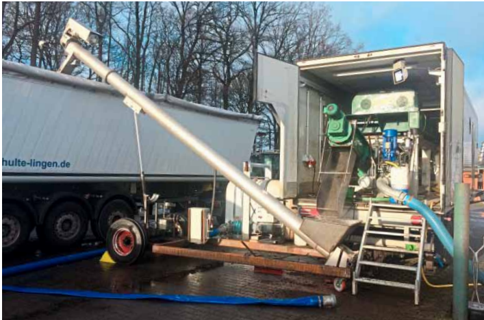
Mobile Anlage zur Separation: Links der Lkw verfrachtet die Nährstoffe in Ackerbauregionen. Nötig ist möglichst effizientes Aufbereiten.
